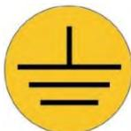
Sämtliche elektrisch leitfähigen Teile, die sich im Arbeitsbereich von 5 m um jede Kabinenöffnung herum befinden, und insbesondere die zu beschichtenden Werkstücke, sind nachhaltig zu erden. Der Erdableitungswiderstand jedes Werkstücks darf maximal 1 MOhm betragen. Dieser Widerstand muss regelmässig bei Arbeitsbeginn überprüft werden.
