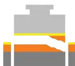
Fallo parcial de revestimiento
