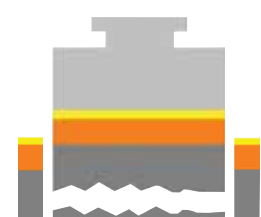
Fallo de hormigón
