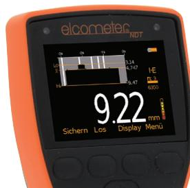
2D-Querschnitt-B-Bildanzeige, ideal für die relative Tiefenanalyse geeignet.
