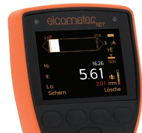
Im Scanmodus erfasst das Messgerät Messwerte mit einer Rate von 16 Hz (16 Messwerte pro Sekunde).
