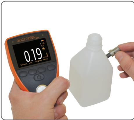
Die Ultraschall-Dickenmessgeräte der Produktreihe PTG sind von 0,15mm (0,006") bis 25,40mm (1,000") auf  $\pm 1\%$  genau.
