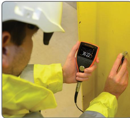
Die Messgeräte bieten sämtliche Merkmale und Funktionen zur Messung der Materialdicke und Schallgeschwindigkeit an praktisch jedem Material in unterschiedlichsten Anwendungen.
